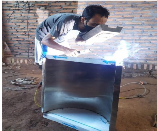
Gambar 9. Pembuatan Penampung Minyak
