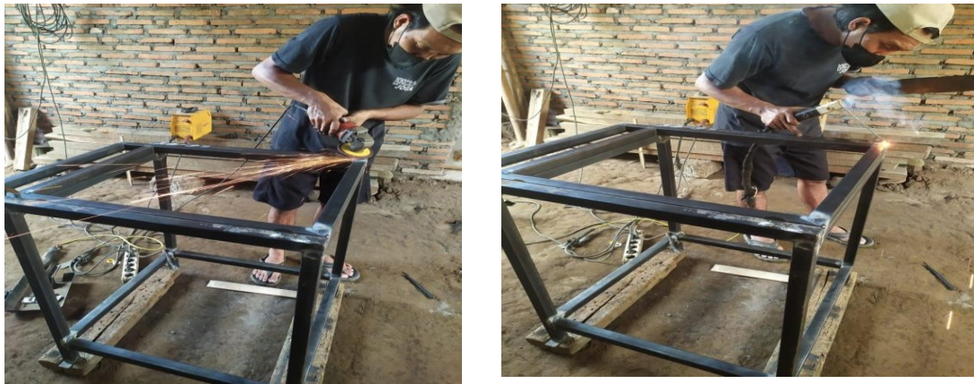
Gambar 7. Perakitan Kerangka/Body Mesin
