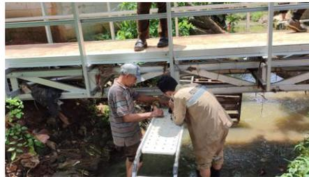
Gambar 20. Pengujian Pembebanan Jembatan
