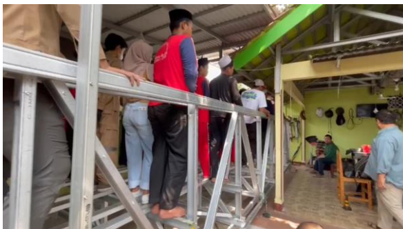
Gambar 9. Pengujian kekakuan struktur jembatan baja ringan
