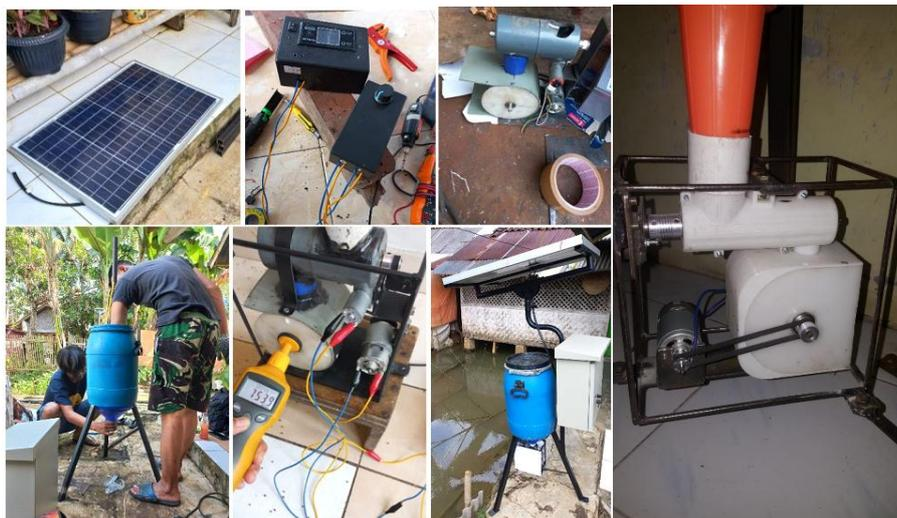
Gambar 5. Perakitan dan Percobaan Alat (Prototype dan Desain Jadi)
