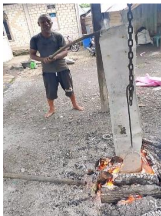
Gambar 2. Proses peleburan limbah aluminium menjadi cairan timah.
