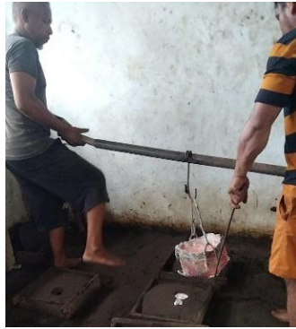
Gambar 4. Proses penuangan aluminium cair ke dalam cetakan
