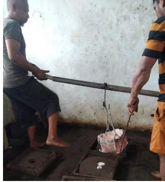
Gambar 4. Proses penuangan aluminium cair ke dalam cetakan
