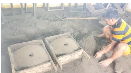
Gambar 3. Pengrajin sedang membuat pola cetakan dengan campuran tanah dan pasir
